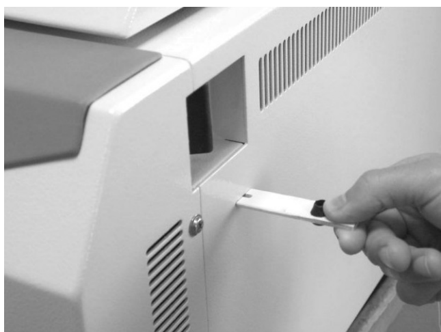
Figura 1. Inserte horizontalmente la herramienta de desbloqueo en el orificio del lado derecho del instrumento.
