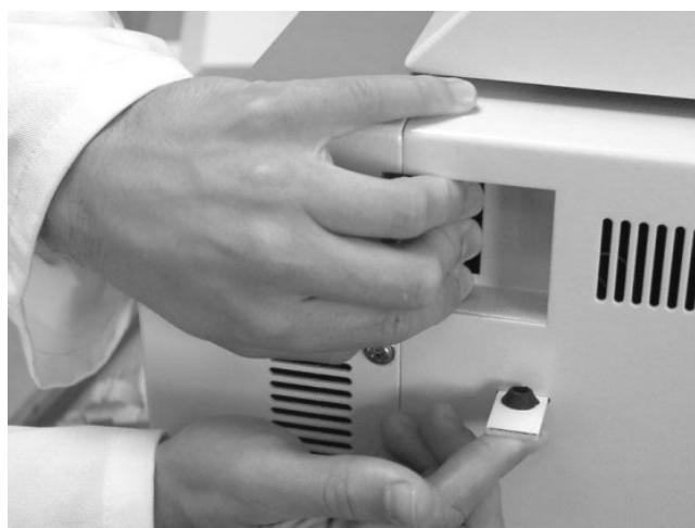
Figura 1. Inserte horizontalmente la herramienta de desbloqueo en el orificio del lado derecho del instrumento.
